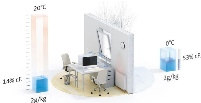
**Abb. 1** Absolute und relative Luftfeuchte bei einer Außenlufttemperatur von 0 °C und einer Innenlufttemperatur von +20 °C (Quelle Fachverband Gebäude-Klima e. V. FGK)
