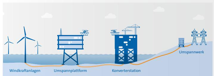
**Bild 3:** Der Weg des Stroms geht von der Windkraftanlage zur Sammelstation, dann zur Umspannplattform und von dort aus zur Zentralstation an Land. (Quelle: Condair).
