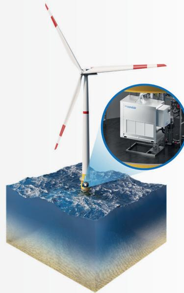
**Bild 5:** Windkraftanlage mit Luftentfeuchter im Turm an der Netzleitung. (Quelle: Condair)
