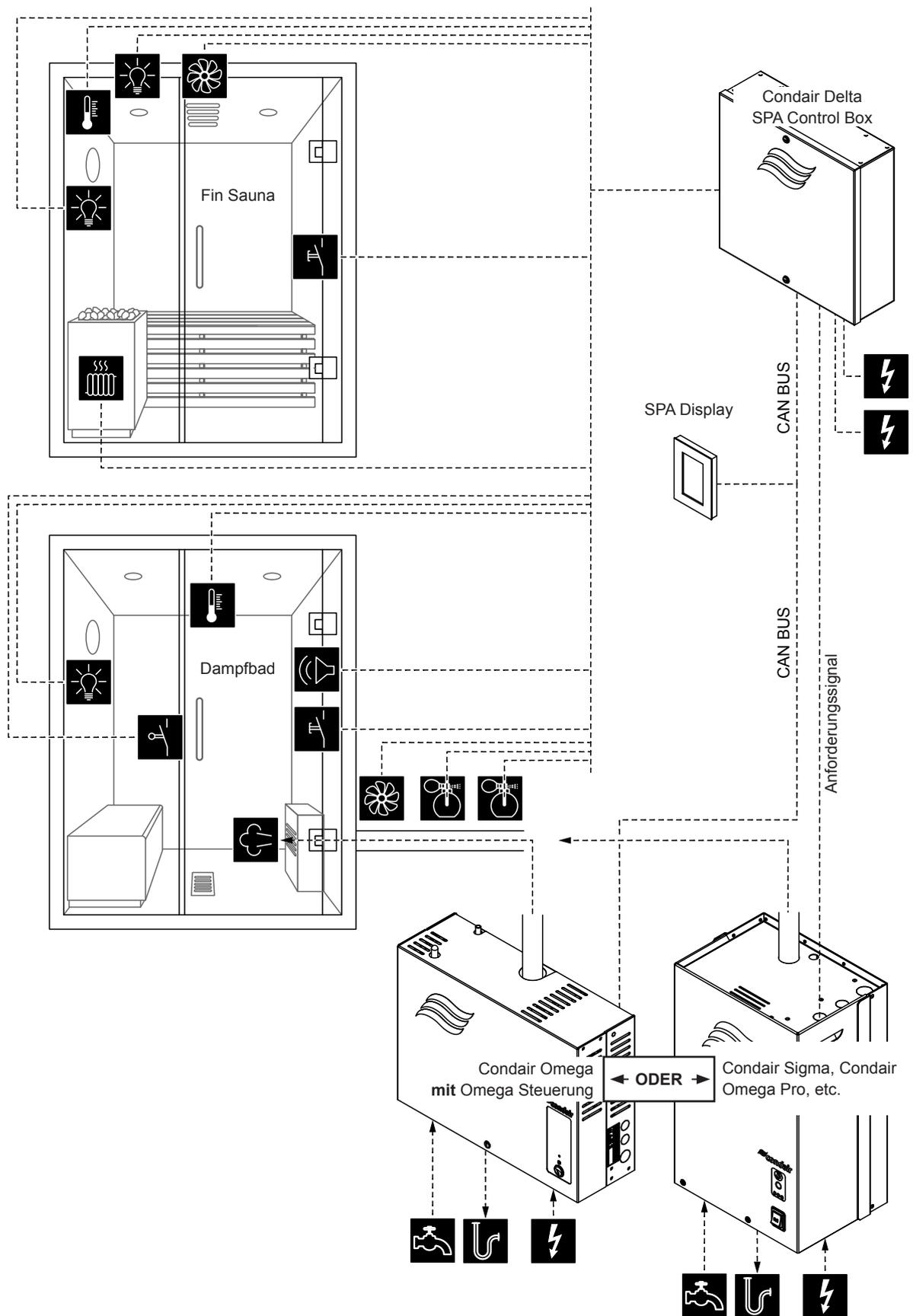
Abb. 8: Condair Delta SPA Control Box mit Ausrüstung Fin Sauna für Doppelkabinenanwendungen für kleine Kabinen
