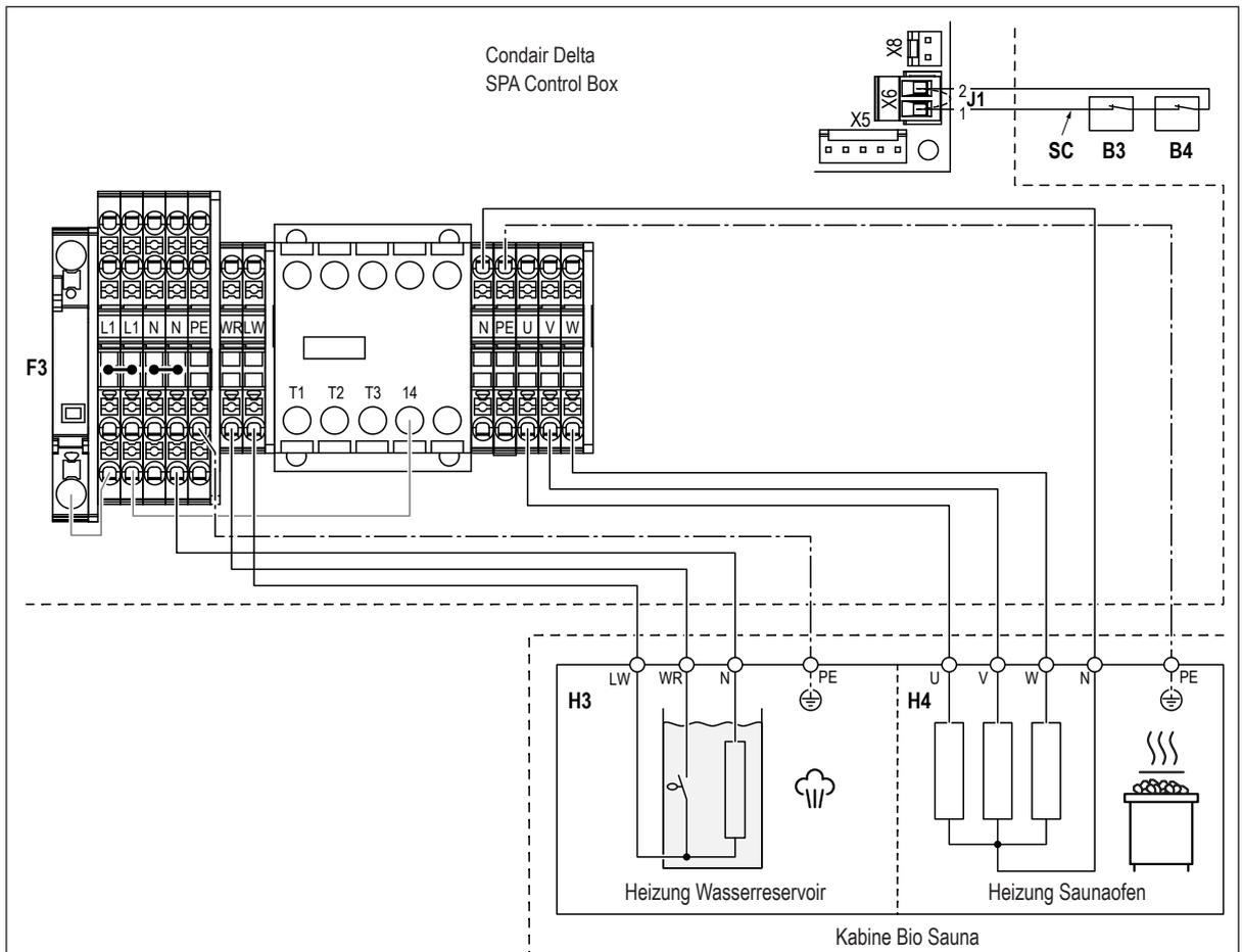
Die Heizung "H3" des Wasserreservoirs ("LW", "WR", "N" und "PE") und die Heizung für den Saunaofen "H4" ("U", "V", "W", "N" und "PE") werden gemäss dem Elektroschema mit einem vierpoligen bzw. fünfpoligen Kabel an die entsprechenden Steckklemmen in der Condair Delta SPA Control Box angeschlossen.
