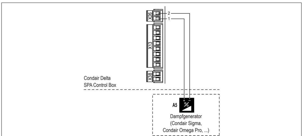
Das Anforderungssignal "A5" für die Ansteuerung des Dampfgenerators (Condair Sigma, Condair Omega Pro, etc.) wird gemäss dem Elektroschema an die Klemmen "1" (+) und "2" (-) des Klemmenblocks "X26" auf der SPA Steuerplatine in der Condair Delta SPA Control Box angeschlossen.
