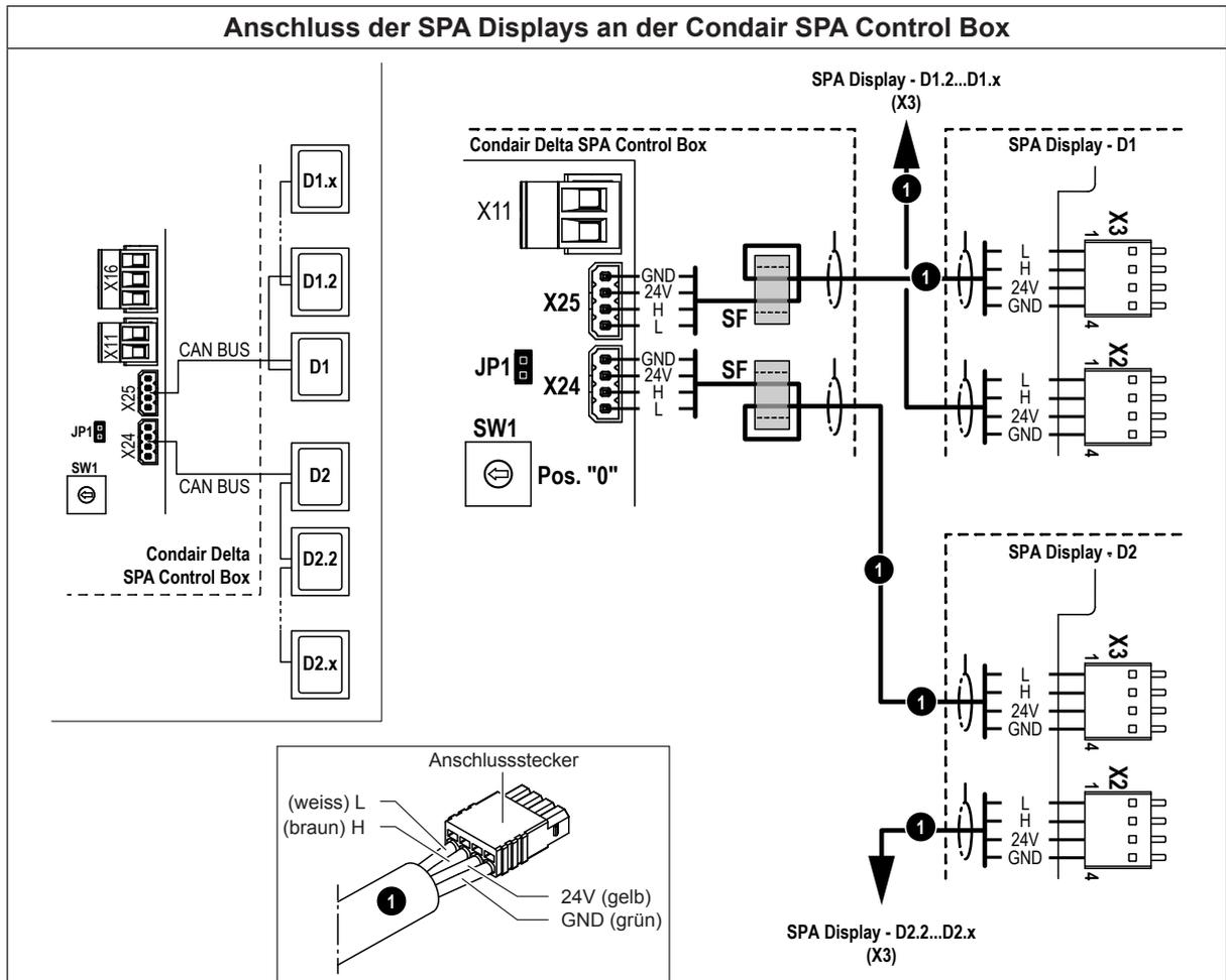
Die als Zubehör erhältlichen externen SPADisplays "D1" und "D2" werden gemäss dem Anschlussschema (siehe oben) über ein CAN BUS-Kabel an den CAN BUS-Anschluss "X25" bzw. "X24" angeschlossen. An beide SPA Displays "D1" und "D2" können weitere SPA Displays (total 8 SPA Displays) über den CAN BUS angeschlossen werden. Detaillierte Hinweise dazu finden Sie in der separaten Anleitung, die mit den externen SPA Displays mitgeliefert wird.
