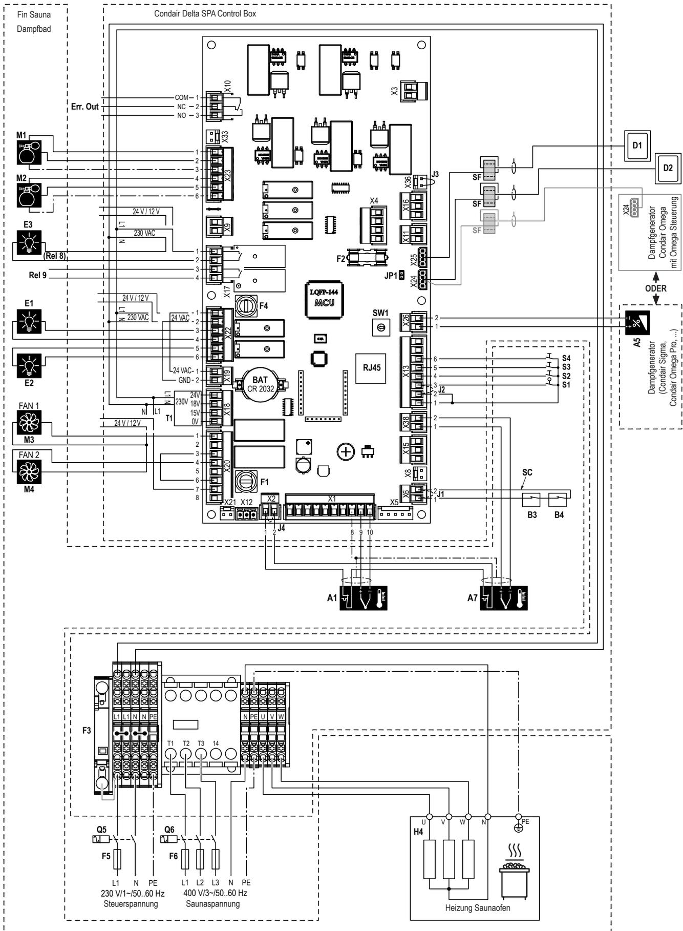
**Legende Elektroschema Condair Delta SPA Control Box für Doppelkabinenanwendung (Fin Sauna / Dampfbad), Saunaofen intern gespeisen**
