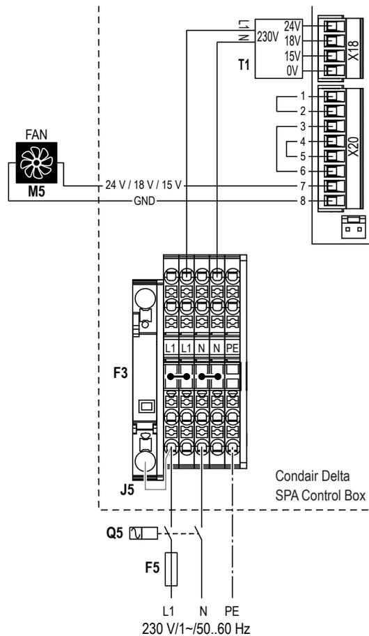
Der 3-Stufenventilator "M5" und die entsprechenden Kabelbrücken werden gemäss dem Elektroschema an die entsprechenden Klemmen des Klemmenblocks "X20" auf der SPA Platine in der Condair Delta SPA Control Box angeschlossen.
