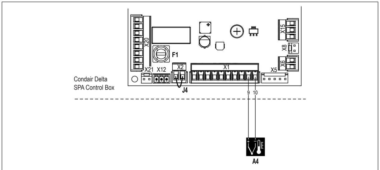
Der Temperatursensor "A4" für die Erfassung der Temperatur der Wandheizung wird gemäss dem Elektroschema an die Klemmen "1" (+) und "2" (-) des Klemmenblocks "X1" auf der SPA Platine in der Condair Delta SPA Control Box angeschlossen.
