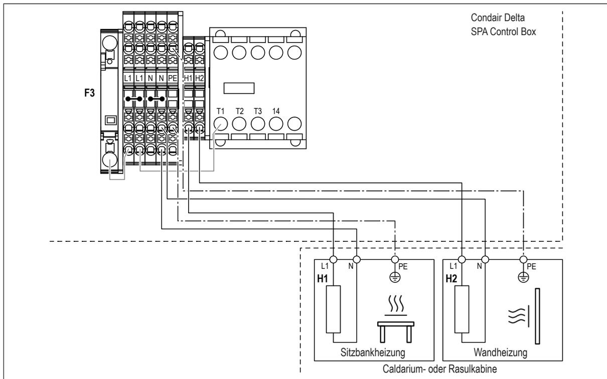
Die Sitzbankheizung "H1" ("L1", "N" und "PE") und die Wandheizung "H2" ("L1", "N" und "PE") werden gemäss dem Elektroschema mit dreipoligen Kabeln an die entsprechenden Steckklemmen in der Condair Delta SPA Control Box angeschlossen.
