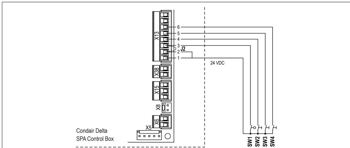
Der Schalter "S1" (Türschalter) und die Taster "S2" (Dampfbad Ein/Aus), "S3" (Licht 1 Ein/Aus) und "S4" (Licht 2 oder Dampfstoss Ein/Aus) für das manuelle Schalten der entsprechenden Komponenten werden gemäss dem Elektroschema an die entsprechenden Klemmen des Klemmenblocks "X13" auf dem SPA Steuerprint angeschlossen. Die Schalter bzw. Taster werden mit 24 VDC betrieben.
