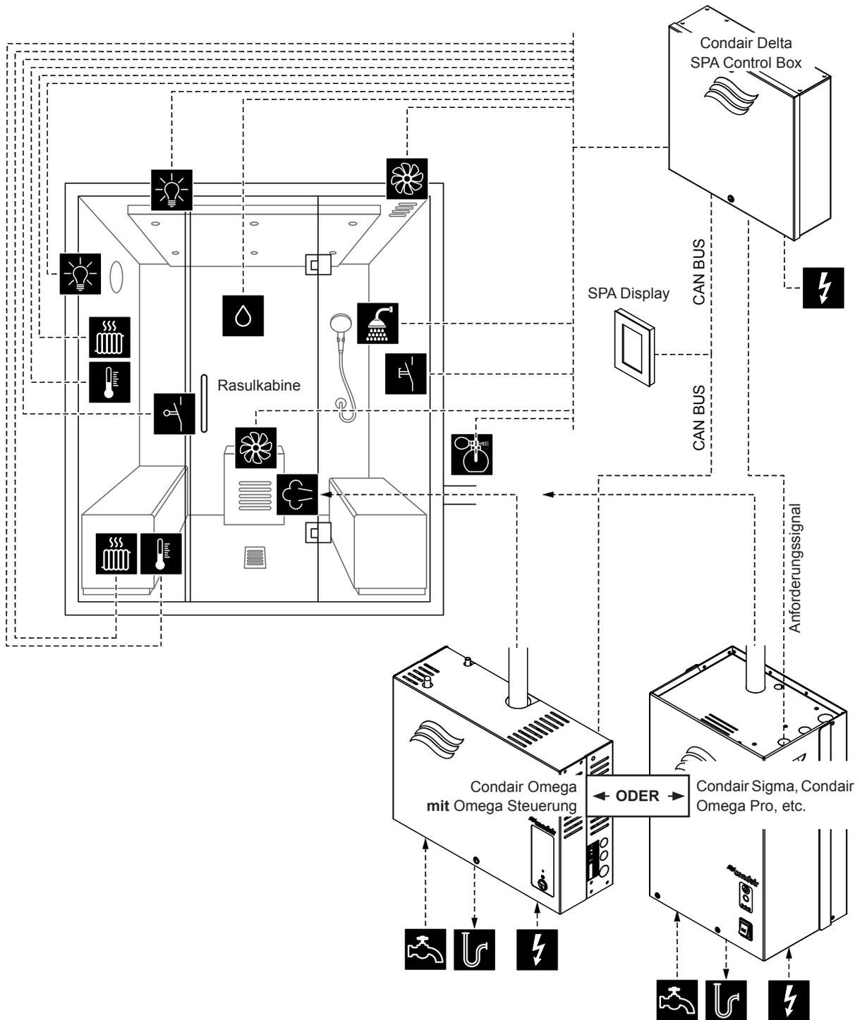
Abb. 4: Condair Delta SPA Control Box mit Ausrüstung für Rasulanwendung
