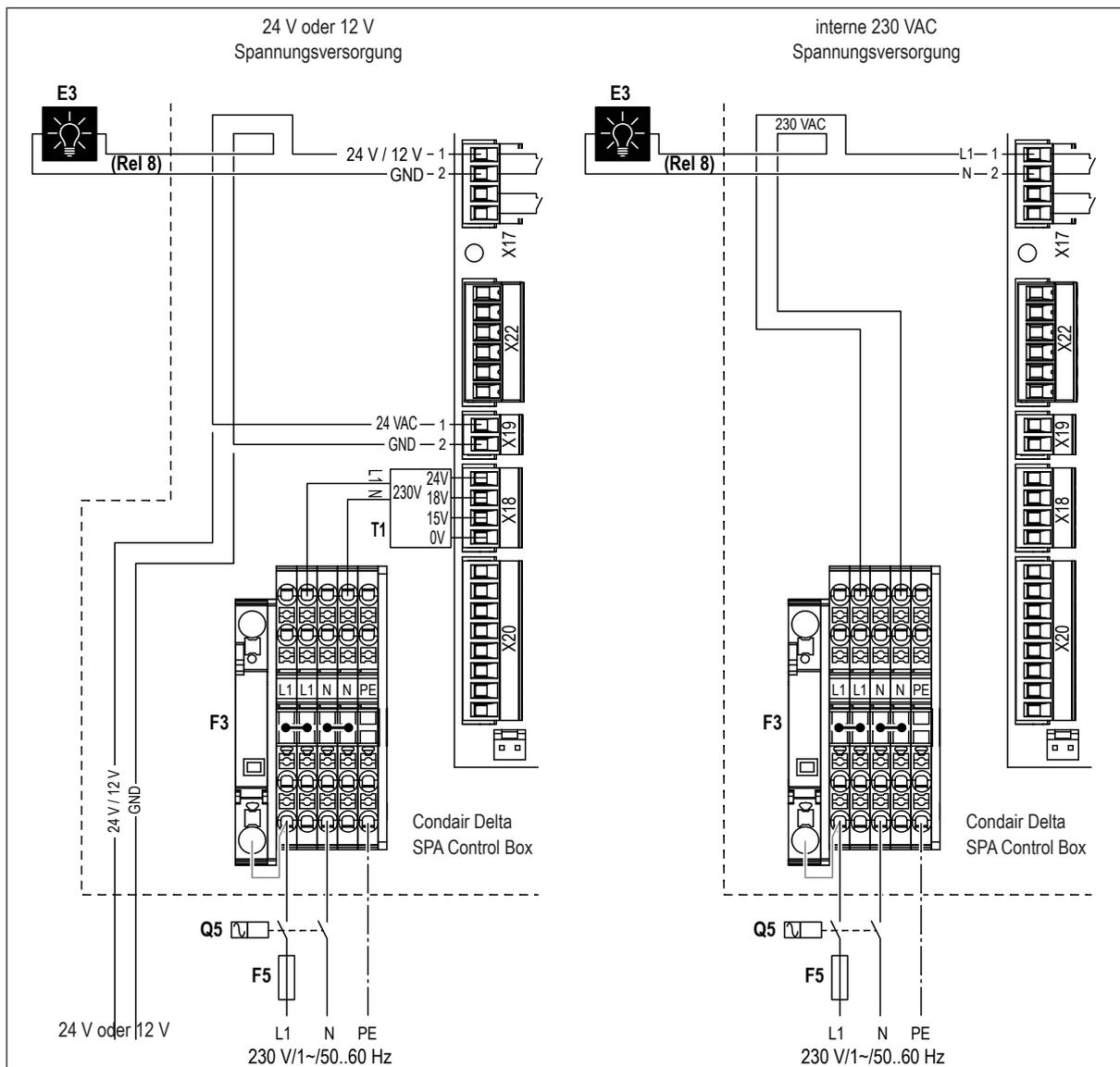
Das Farblicht "E3" für die Saunakabine für Doppelkabinenanwendungen für kleine Kabinen wird gemäss dem Elektroschema an die entsprechenden Klemmen des Klemmenblocks "X17" auf der SPA Steuerplatine in der Condair Delta SPA Control Box angeschlossen.
