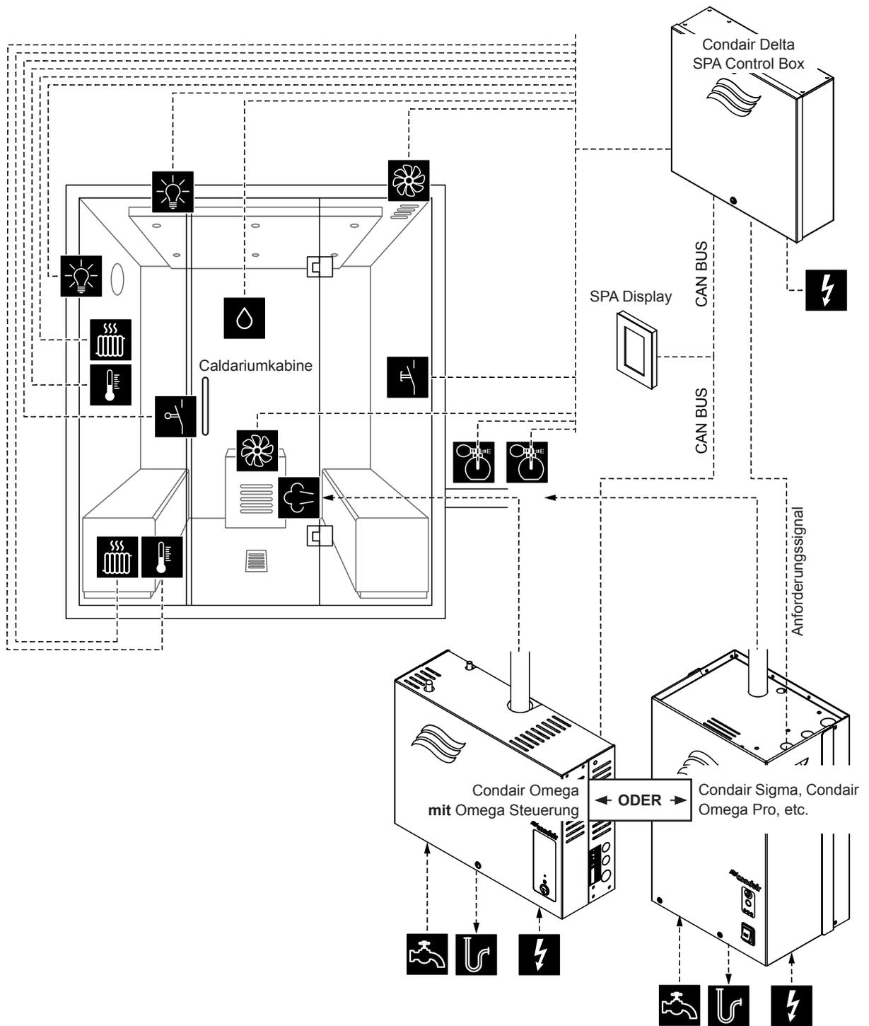
Abb. 3: Condair Delta SPA Control Box mit Ausrüstung für Caldariumanwendung
