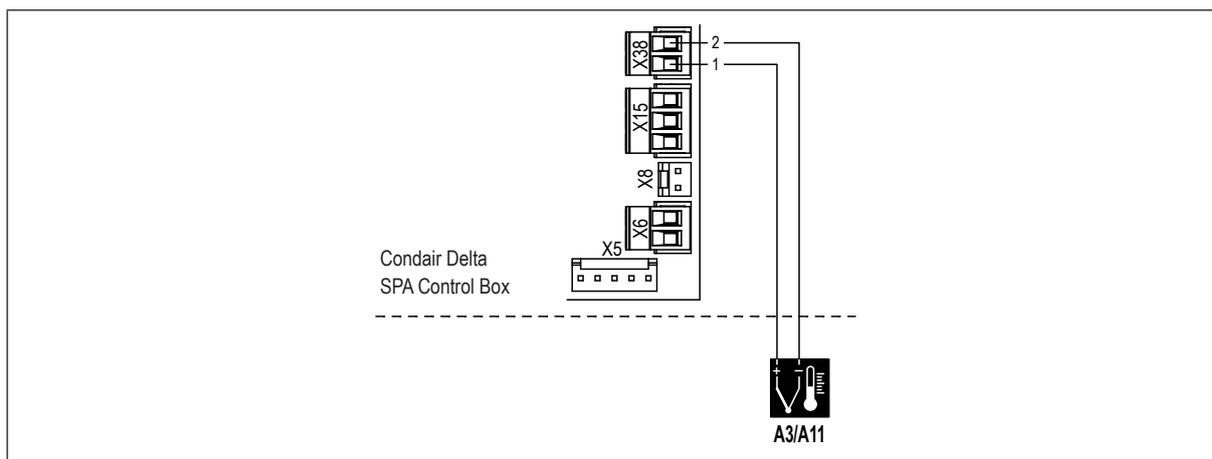
Der Temperatursensor "A3" für die Erfassung der Temperatur der Sitzbankheizung oder der Temperatursensor "A11" für die Erfassung der Saunaofentemperatur wird gemäss dem Elektroschema an die Klemmen "1" (+) und "2" (-) des Klemmenblocks "X38" auf der SPA Platine in der Condair Delta SPA Control Box angeschlossen.
