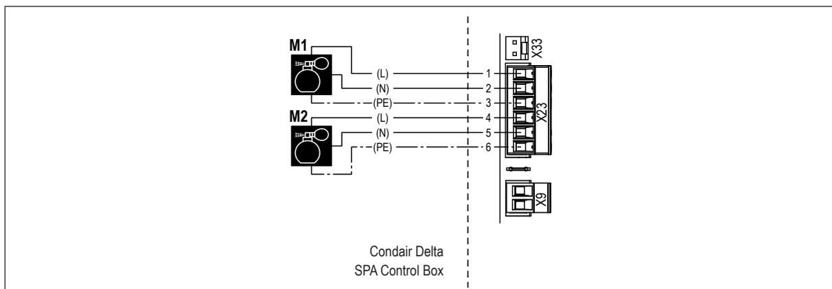
Die Duftstoffpumpen "M1" und "M2" werden gemäss dem Elektroschema an die entsprechenden Klemmen des Klemmenblocks "X23" auf der SPA Platine in der Condair Delta SPA Control Box angeschlossen.
