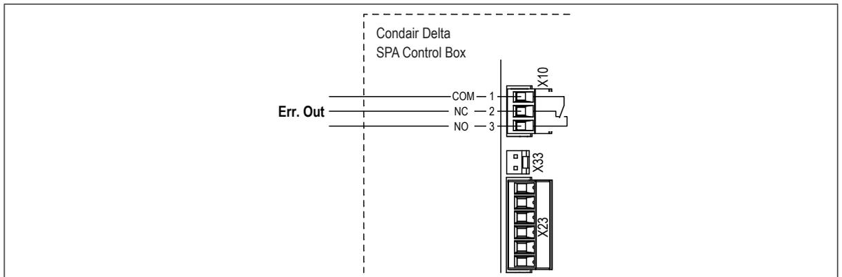
Der potentialfreie "Err. Out"-Kontakt kann für die Fehlersignalisierung an externe Geräte verwendet werden. Im Normalbetrieb (keine Fehler vorhanden) ist der Kontakt zwischen 1-3 geschlossen. Im Fehlerfall (eine Warnung gilt nicht als Fehler) ist der Kontakt zwischen 1-2 geschlossen. Hinweis: Bei ausgeschaltetem Gerät ist der Kontakt in Ruheposition zwischen 1-2.
