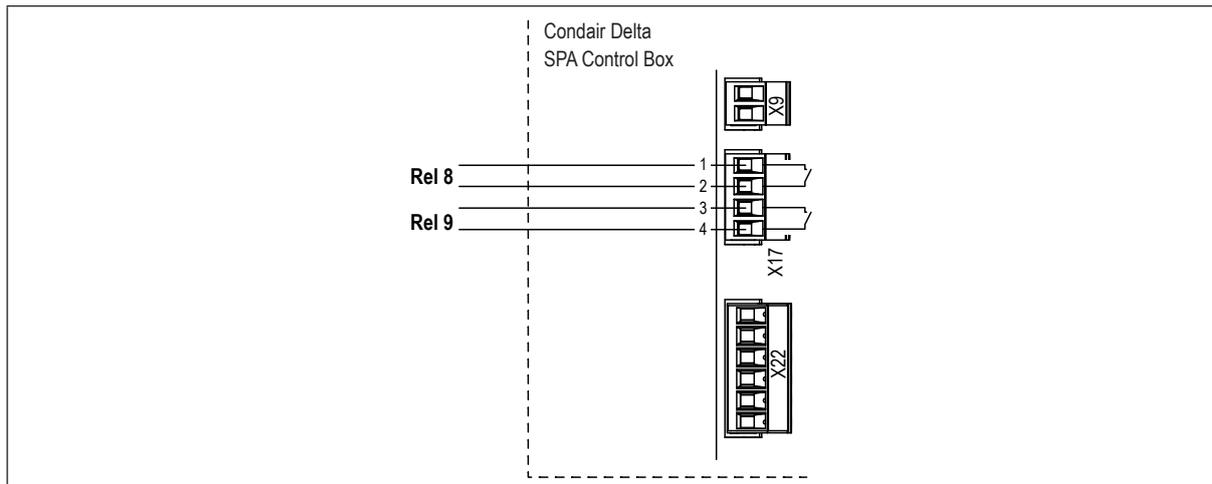
Die potentialfreien Relaiskontakte "Rel 8" und "Rel 9" dienen zur Ansteuerung von Komponenten (z.B. Lautsprecher, zusätzliches Licht) in der SPA Kabine. Diese Komponenten werden gemäss dem Elektroschema an die Klemmen "1" und "2" ("Rel 8") bzw. "3" und "4" ("Rel 9") des Klemmenblocks "X17" auf der SPA Platine in der Condair Delta SPA Control Box angeschlossen.
