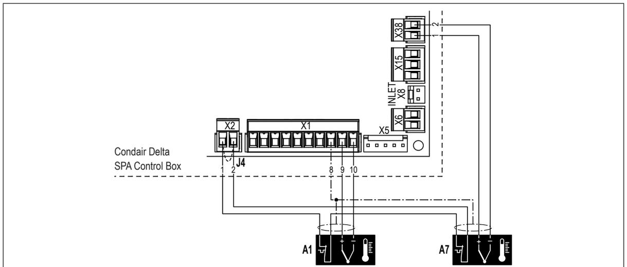
Die Temperatursensoren "A1" und "A7" werden gemäss dem Elektroschema an die Klemmen "9" (+) und "10" (-) des Klemmenblocks "X1" auf der SPA Steuerplatine in der Condair Delta SPA Control Box angeschlossen.
