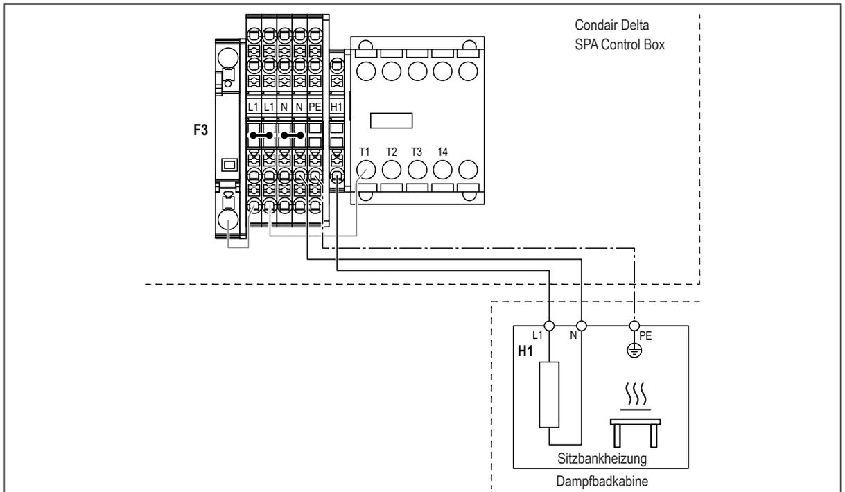
Die Sitzbankheizung "H1" ("L1", "N" und "PE") wird gemäss dem Elektroschema mit einem dreipoligen Kabel an die entsprechenden Steckklemmen in der Condair Delta SPA Control Box angeschlossen.
