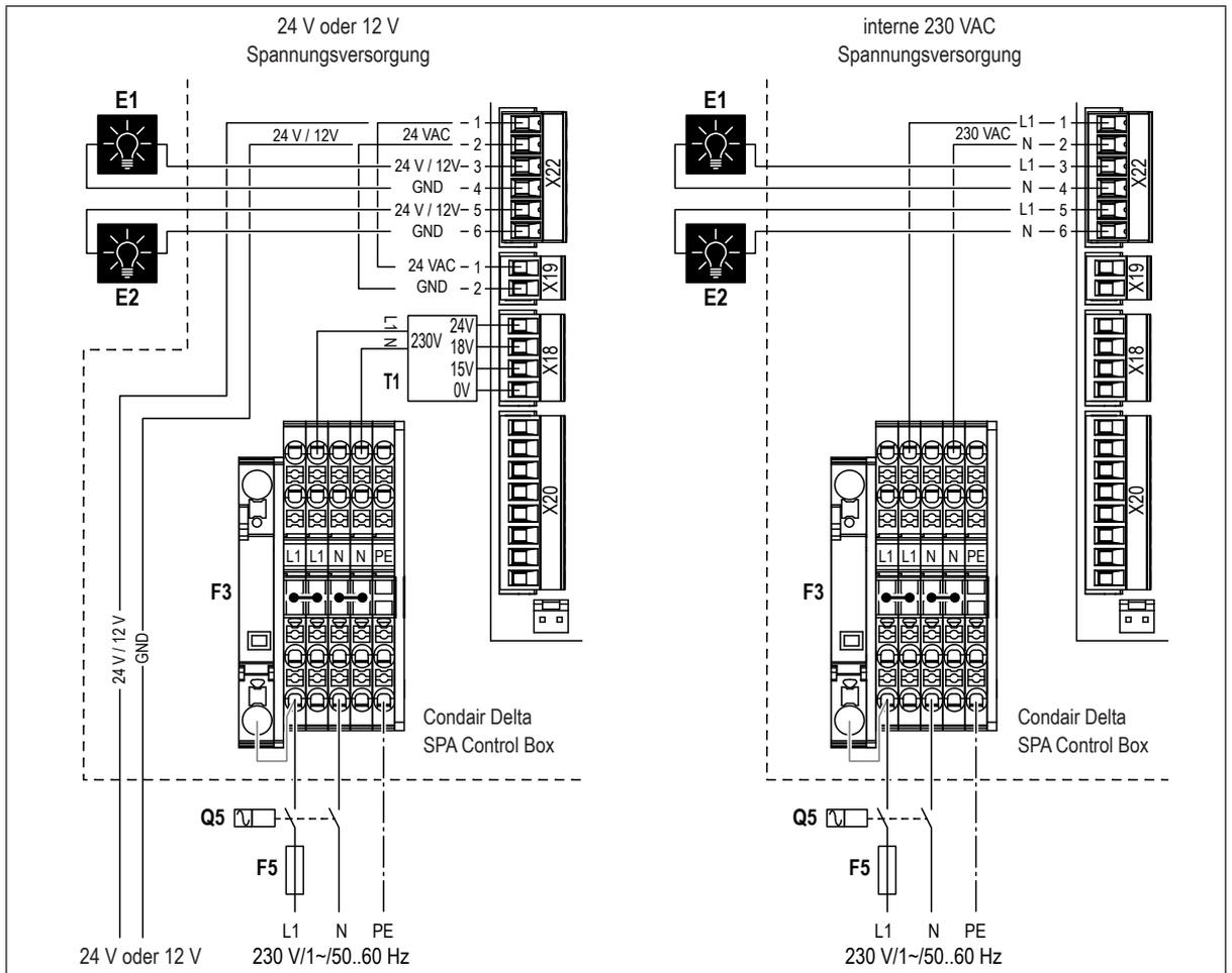
Das Kabinenlicht "E1"(Licht 1) und "E2" (Licht 2) wird gemäss dem Elektroschema an die entsprechenden Klemmen des Klemmenblocks "X22" auf der SPA Platine in der Condair Delta SPA Control Box angeschlossen. Die Spannungsversorgung des Kabinenlights erfolgt abhängig vom verwendeten Leuchtmittel entweder über die interne 230 VAC-Versorgung oder über die 24 VAC-Versorgung vom optionalen Trafo T1.
