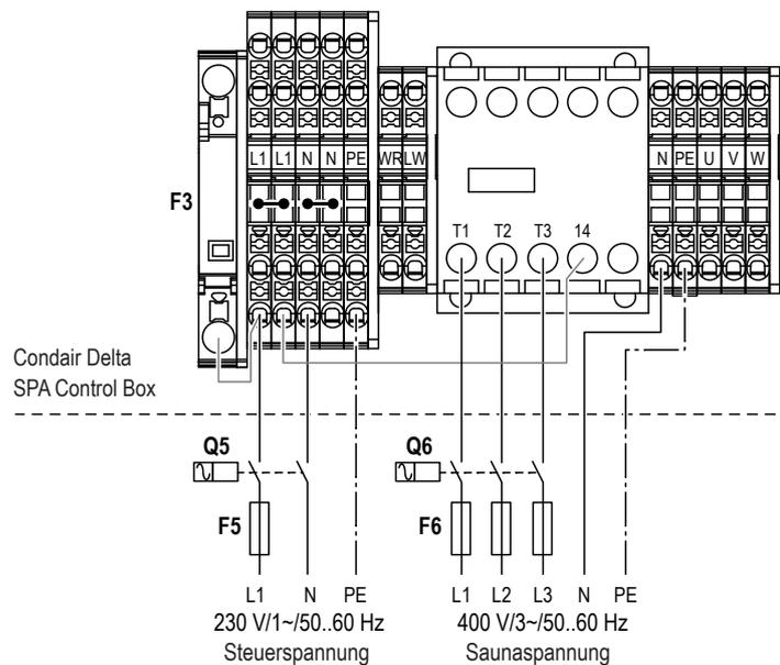
Der Anschluss der 230 V/1~/50..60Hz Spannungsversorgung ("L1", "N" und "PE") für die Steuerung des Zubehörs und für die Heizung des Wasserreservoirs (Steuerspannung) erfolgt gemäss dem Elektroschema an die entsprechenden Steckklemmen ("L1", "N" und "PE") in der Condair Delta SPA Control Box.
