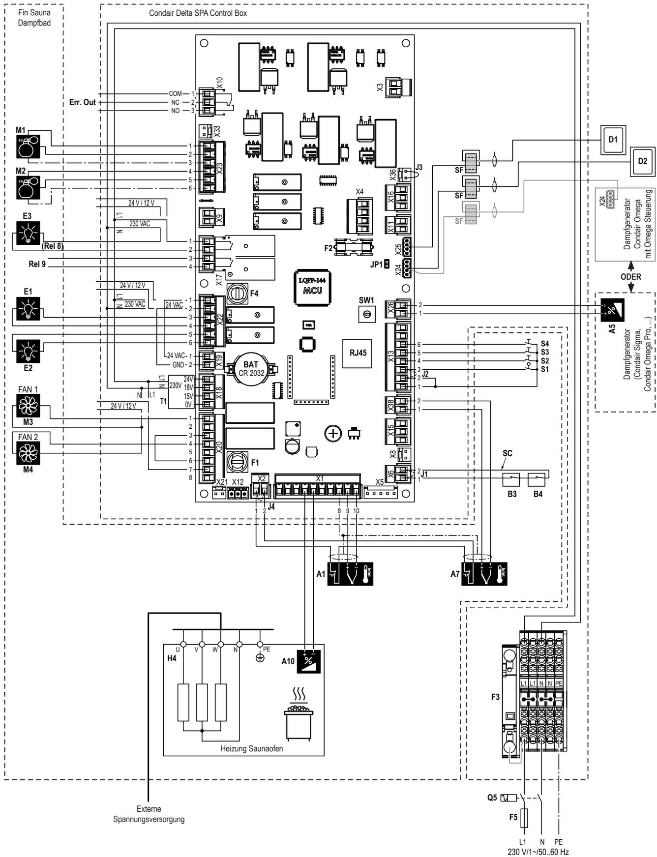
**Legende Elektroschema Condair Delta SPA Control Box für Doppelkabinenanwendung (Fin Sauna / Dampfbad), Saunaofen extern gespiesen**
