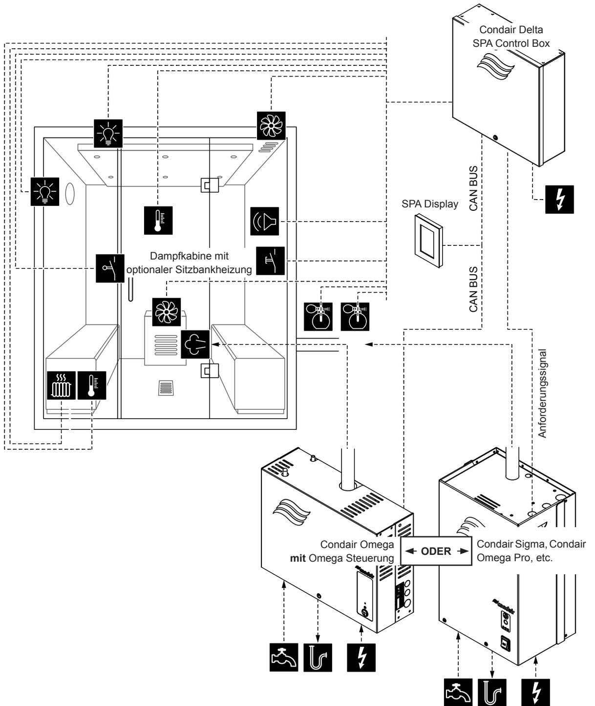
Abb. 2: Condair Delta SPA Control Box mit Ausrüstung für Dampfbadanwendung mit optionaler Sitzbankheizung
