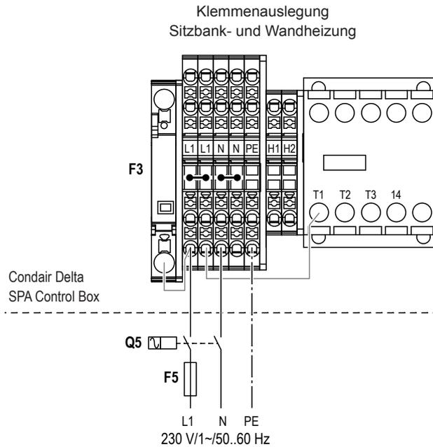
Der Anschluss der 230 V/1~/50..60Hz Spannungsversorgung ("L1", "N" und "PE") für die Condair Delta SPA Control Box und die Sitzbank- und Wandheizung für Caldarium- und Rasulanwendung erfolgt gemäss dem Elektroschema an die entsprechenden Steckklemmen ("L1", "N" und "PE") in der Condair Delta SPA Control Box.
