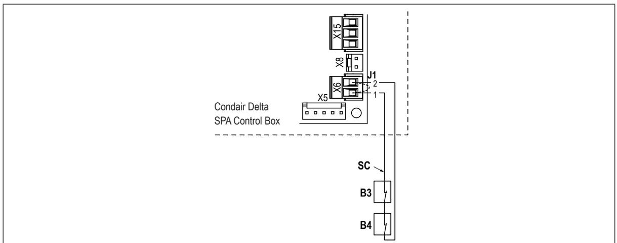
Die potentialfreien Kontakte externer Überwachungsgeräte "B3" (z.B. Not-Aus) und "B4" (Sicherheitselement Saunaofen) der externen Sicherheitskette "SC" werden gemäss dem Elektroschema in Serie (falls mehr als ein Überwachungsgerät angeschlossen wird) an die Klemmen des Klemmenblocks "X6" auf der SPA Steuerplatine in der Condair Delta SPA Control Box angeschlossen.
