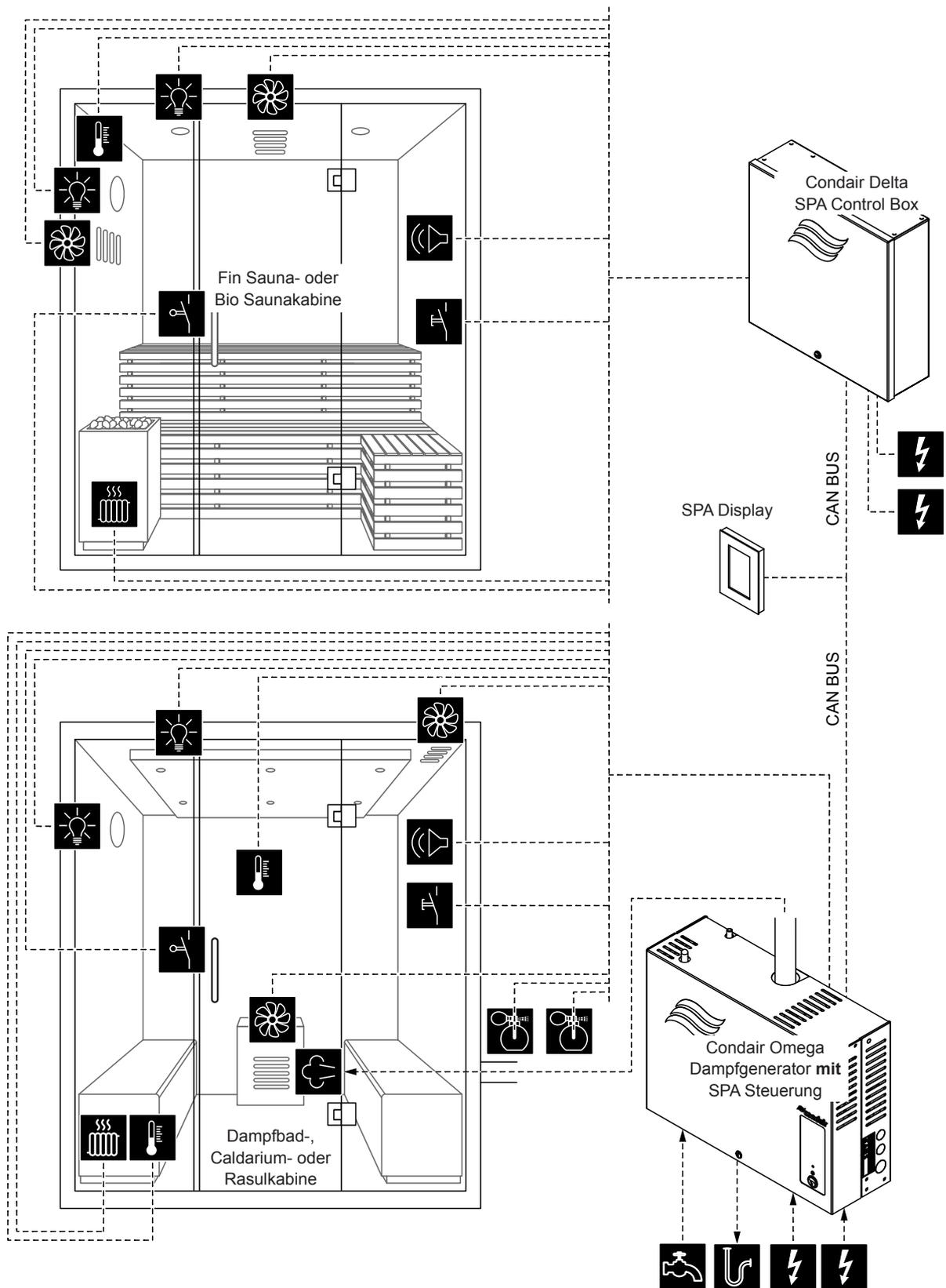
Abb. 9: Condair Delta SPA Control Box und Condair Omega mit SPA Steuerung für Doppelkabinenanwendungen für mittelgrosse Kabinen
