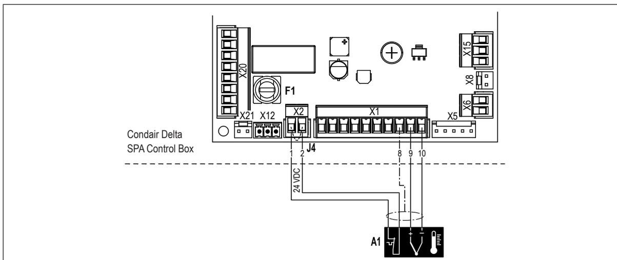
Der Temperatursensor wird an die Klemmen "9" (+) und "10" (-) des Klemmenblocks "X1" auf der SPA Steuerplatine angeschlossen. Folgende Sensoren werden unterstützt: KTY, PT100 und PT1000.
