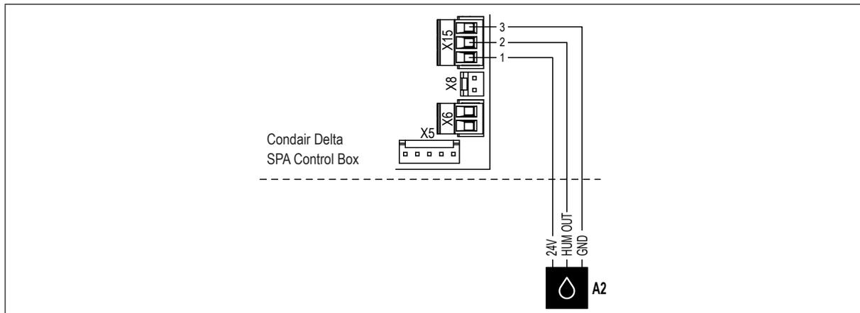
Der Feuchtesensor wird gemäss dem Elektroschema an die Klemmen "1" (24V), "2" (HUM OUT) und "3" (GND) des Klemmenblocks "X15" auf der SPA Steuerplatine angeschlossen.
