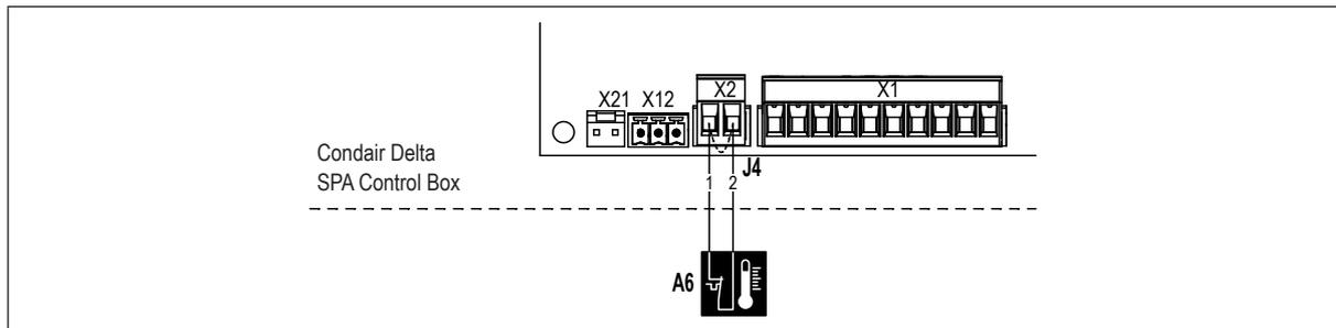
Der Kabinen-Übertemperaturschalter "A6" wird gemäss dem Elektroschema an die Klemmen "1" (+) und "2" (-) des Klemmenblocks "X2" auf der SPA Steuerplatine in der Condair Delta SPA Control Box angeschlossen. Falls Kabelbrücke "J4" installiert ist, diese zuerst entfernen.
