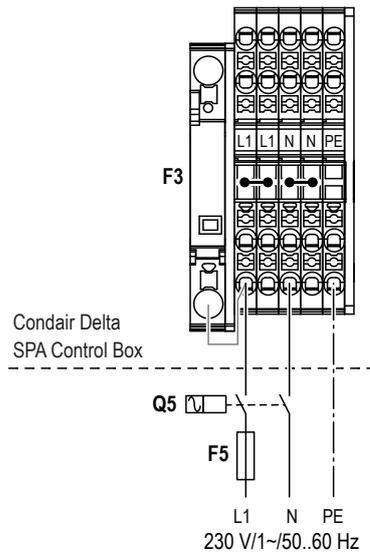
Der Anschluss der 230 V/1~/50..60Hz Spannungsversorgung ("L1", "N" und "PE") für die Condair Delta SPA Control Box erfolgt gemäss dem Elektroschema an die entsprechenden Steckklemmen ("L1", "N" und "PE") in der Condair Delta SPA Control Box.
