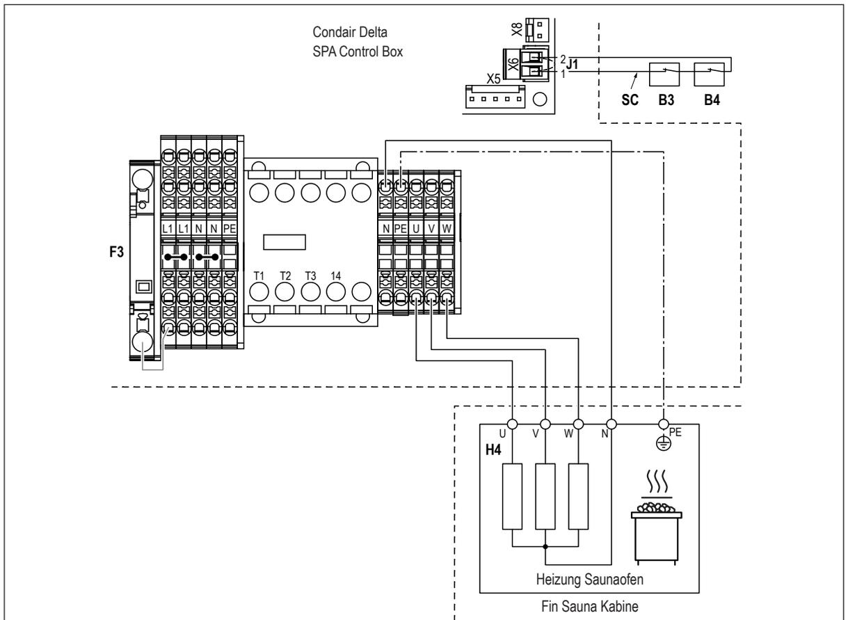
Die Heizung für den Saunaofen "H4" ("U", "V", "W", "N" und "PE") wird gemäss dem Elektroschema mit einem fünfpoligen Kabel an die entsprechenden Steckklemmen in der Condair Delta SPA Control Box angeschlossen.
