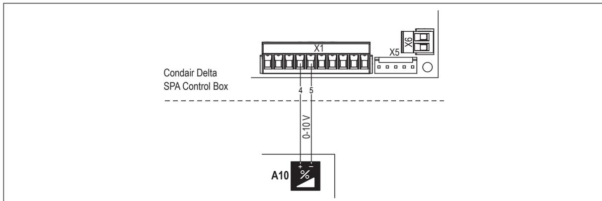
Das Anforderungssignal "A10" für die Ansteuerung eines extern gespiesenen Saunaofens wird gemäss dem Elektroschema an die Klemmen "4" (+) und "5" (-) des Anforderungssignalausgangs des Klemmenblocks "X1" auf der SPA Steuerplatine in der Condair Delta SPA Control Box angeschlossen. Das Ausgangssignal für die Anforderung beträgt 0-10 V und entspricht einem Anforderungsbereich von 0-100%.
