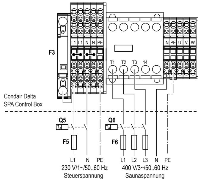
Der Anschluss der 230 V/1~/50..60Hz Spannungsversorgung ("L1", "N" und "PE") für die Steuerung des Zubehörs (Steuerspannung) erfolgt gemäss dem Elektroschema an die entsprechenden Steckklemmen ("L1", "N" und "PE") in der Condair Delta SPA Control Box.
