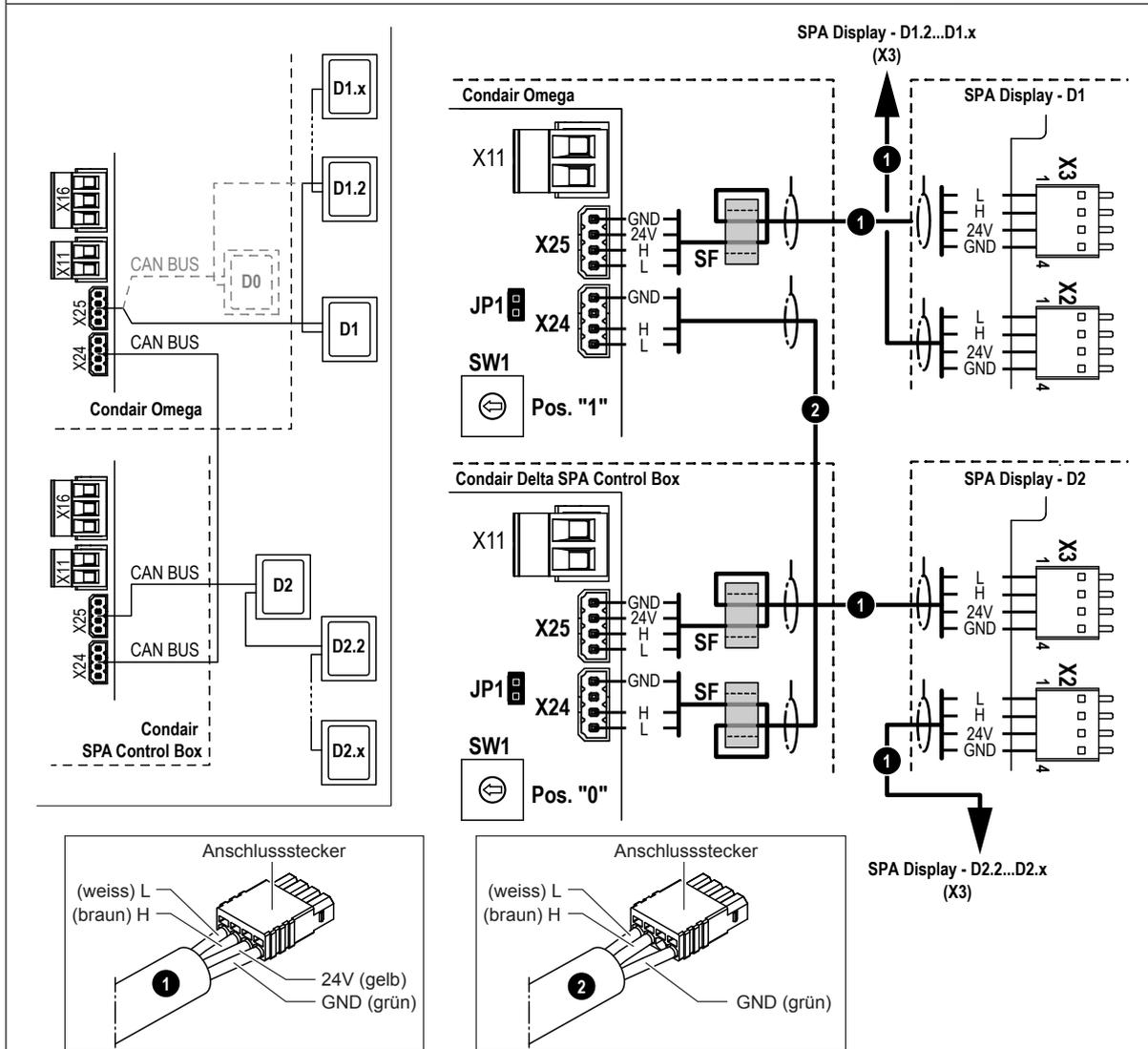
Wird ein Condair Omega in Kombination mit einer Condair Delta SPA Control Box verwendet, muss der CAN BUS-Anschluss "X24" der Condair Delta SPA Control Box über ein CAN BUS-Kabel ohne "24 V" Leiter (Kabel Nr. 2) mit dem CAN BUS-Anschluss "X24" im Steuerkasten des Condair Omega verbunden werden.
