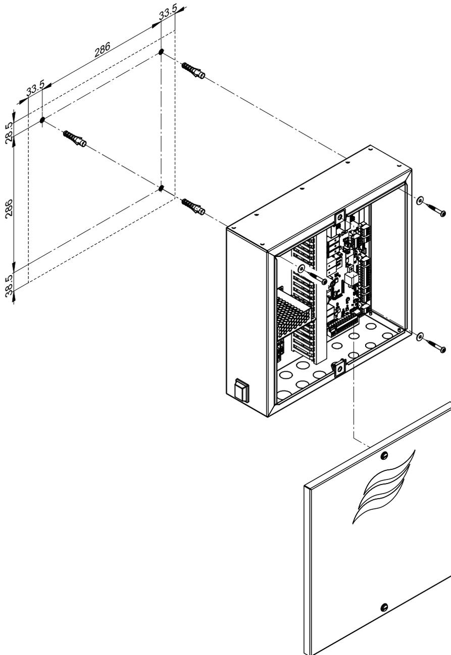
Abb. 11: Condair Delta SPA Control Box montieren
