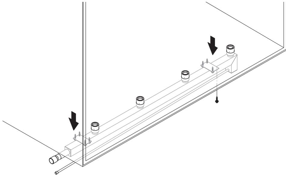
**Vorsicht!** Bis die definitiven Abstützungen montiert sind (Schritt 4), ist der Kollektor mit Hilfsabstützungen gegen Herunterfallen zu sichern.
