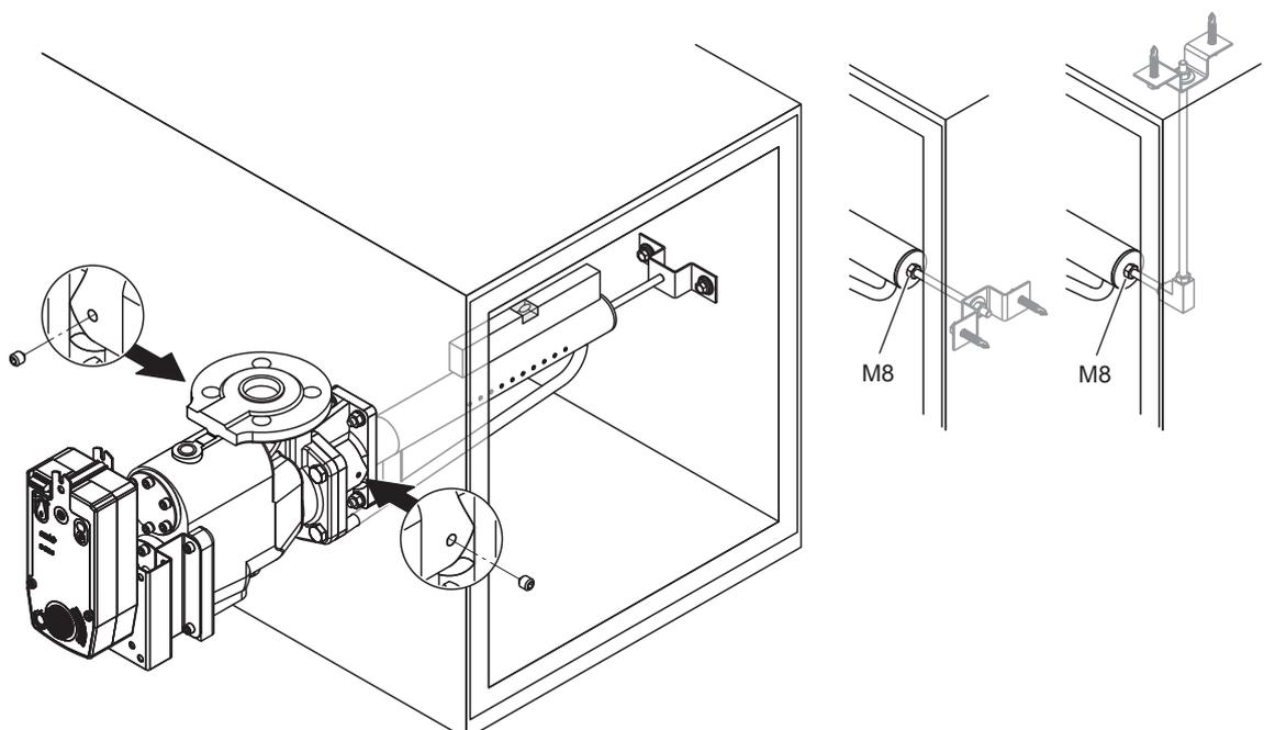
5. Bohrungen auf der Kanalinnenseite mit silikonfreier Dichtungsmasse abdichten.
