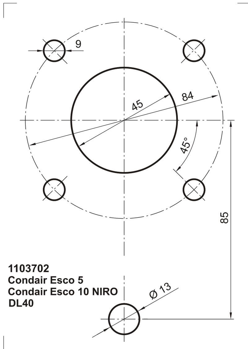
6.2.2 Bohrschablone "1103487" für Esco 10 mit einem Dampfrohr und für Kollektoren DL40
