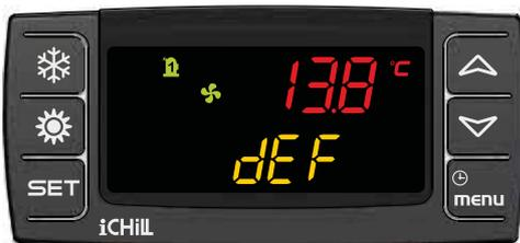
Anzeige der Abtauung bei Geräten mit einem extern angebrachten Thermostat / Hygrostat.
