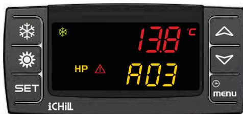
Eine Störungsanzeige wird am Display durch ein
