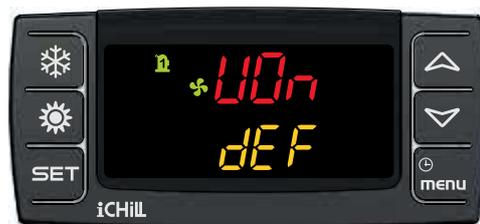
Anzeige der Abtropfzeit nach Abtauung bei Geräten mit einem intern verbauten elektronischen Feuchte- / Temperatursensor.
