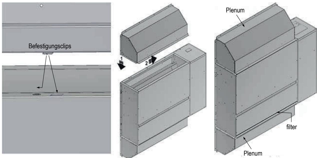
Luftentfeuchter mit Zu- und Abluft Plenum. Sowohl der Luftentfeuchter und das Plenum sind mit einigen Löchern für die Befestigungsschrauben angeordnet, wie in der oberen Abbildung gezeigt.
