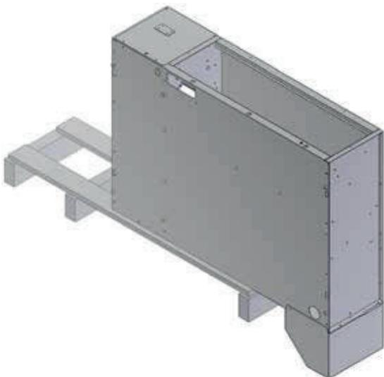
Verwenden Sie zur Montage des ersten Stützfußes die Palette der Transportverpackung als Unterstüzung.
