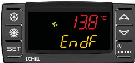
Anzeige der Abtropfzeit nach Abtauung bei Geräten mit einem extern angebrachten Hygrostat / Thermostat
