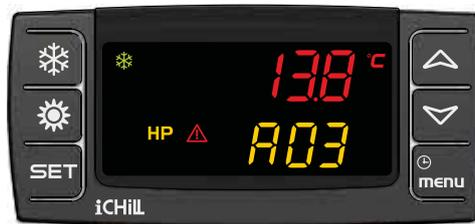
Eine Störungsanzeige wird am Display durch ein
