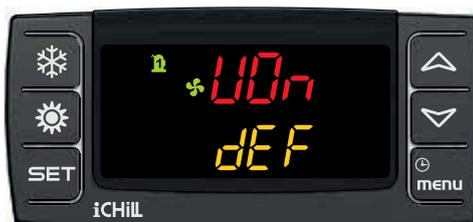
Anzeige der Abtropfzeit nach Abtauung bei Geräten mit einem intern verbauten elektronischen Feuchte/Temperatursensor (Standard).
