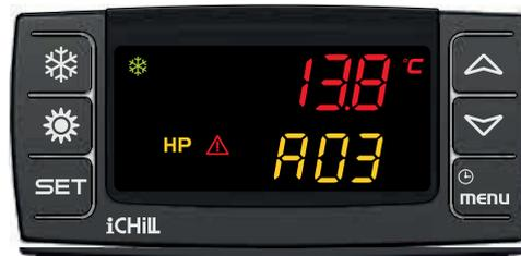
Eine Störungsanzeige wird am Display durch ein
