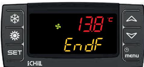
Anzeige der Abtropfzeit nach Abtauung bei Geräten mit einem extern angebrachten Hygrostat / Thermostat (Standard).
