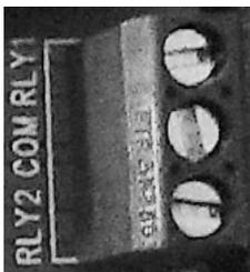
Dabei handelt es sich um zwei spannungsbehaftete NO-Kontakte mit einem gemeinsamen Leiter 12VDC (COM), die mit 100mA pro Ausgang belastet werden dürfen. Der Gesamtstrom beider Ausgänge darf 200mA nicht überschreiten. Wenn Sie potentialfreie Meldeausgänge benötigen, wird der bauseitige Einbau von zwei Trennrelais mit 12 VDC/max. 100 mA empfohlen. Überprüfen Sie die Einbaumaße der Relais vor deren Montage unter den Steuerdeckel.
