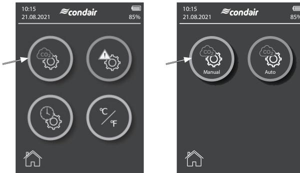
2. Platzieren Sie den Sensor im Freien, beispielsweise ausserhalb des Fensters an der frischen Luft. Aussenluft wird als Referenz herbeigezogen, da diese im Normalfall einen Wert von ca. 400 ppm aufweist.
