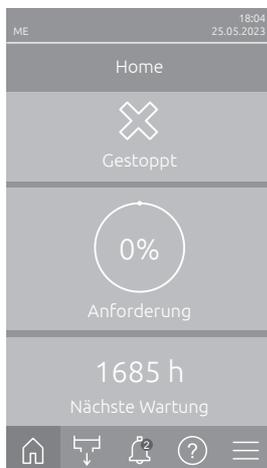
Betriebsstörungen, die einen Weiterbetrieb nicht zulassen oder zu Schäden an der Anlage führen können, werden mit einer Fehlermeldung signalisiert, zusätzlich leuchtet die Status-LED rot. Beim Auftreten einer solchen Störung ist der Betrieb des Condair ME nur noch beschränkt möglich oder der Condair ME **wird gestoppt**.
