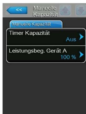
Lassen Sie die Timerfunktion deaktiviert (Timer Kapazität : **"Aus"**) oder deaktivieren Sie die Timerfunktion falls nötig. Legen Sie anschliessend mit dem Parameter "Leistungsbeg. Gerät A" die fixe Leistungsbegrenzung in % bezogen auf die maximale Befeuchterleistung fest (Werkseinstellung: **100 %**, Einstellbereich: **20 ... 100 %**).
