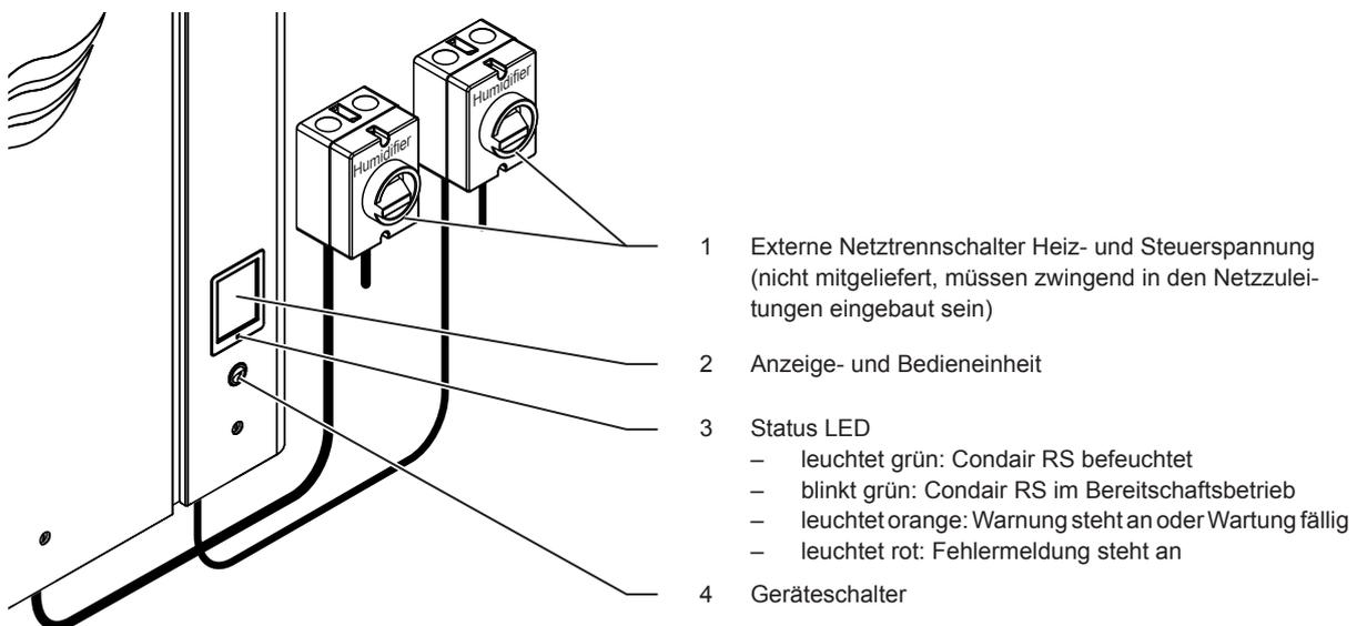
Abb. 4: Anzeige- und Bedienelemente
