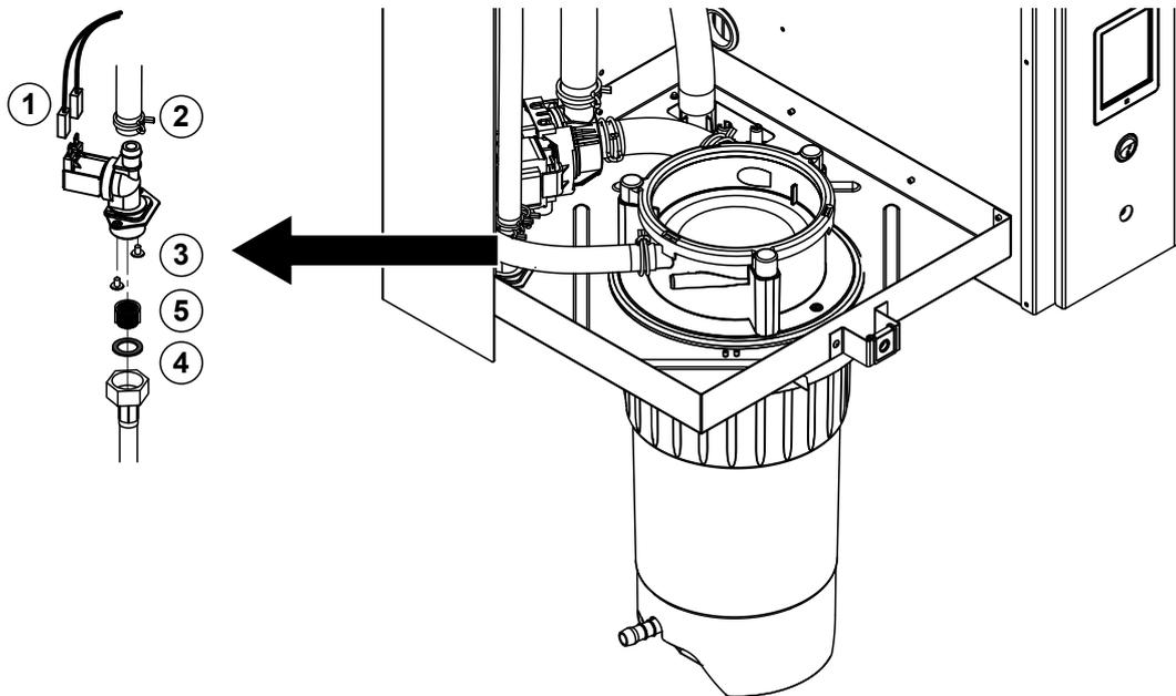
1. Die Elektrokabel von den Anschlüssen abziehen (Polarität der Elektrokabel muss nicht beachtet werden).
