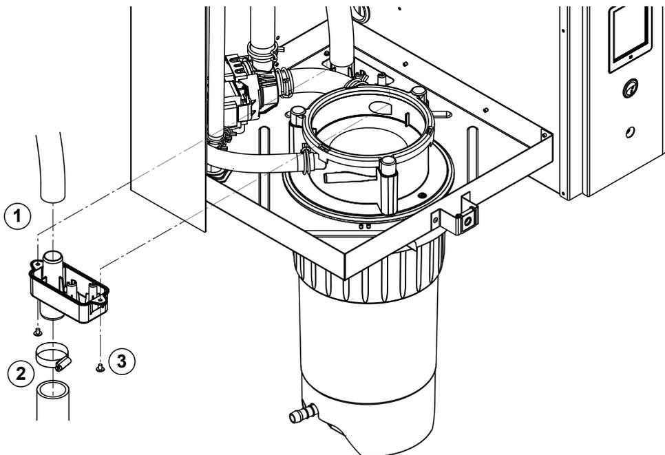
1. Den Ablaufschlauch vom Anschluss am Ablaufbecher abziehen.
