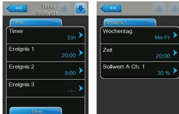
Aktivieren Sie die Timerfunktion ("Timer Sollwert : **"Ein"**). Bei aktivierter Timerfunktion können anschliessend bis zu acht Schaltzeitpunkte (Ereignis 1... Ereignis 8) mit unterschiedlichen Sollwerten definiert werden. Jeder Schaltzeitpunkt ist definiert durch einen Wochentag bzw. Wochentagbereich, die Schaltzeit und den Feuchtesollwert in %rF.
