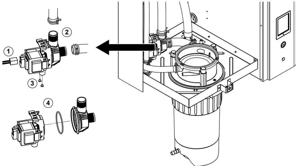
1. Die Elektrokabel von den Anschlüssen abziehen (Polarität der Elektrokabel muss nicht beachtet werden).
