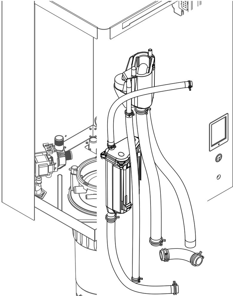
1. Die Schlauchklemmen lösen und alle Schläuche im Gerät von den Anschlüssen abziehen und Schläuche ausbauen.
