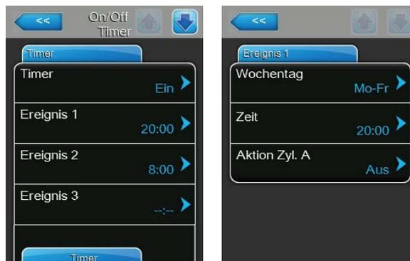
Mit dem Parameter "Timer" aktivieren ("Ein") oder deaktivieren ("Aus") Sie die Ein/Aus-Zeitsteuerung.
