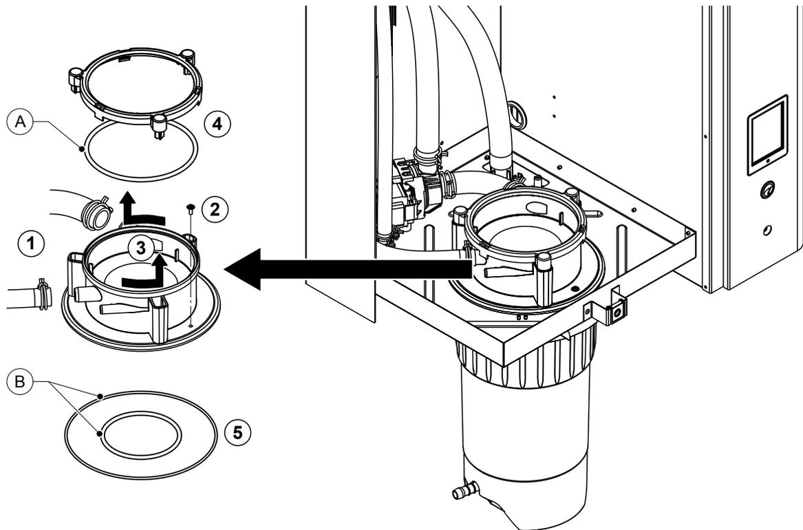
1. Die Schlauchklemmen lösen und die Schläuche von den Anschlüssen abziehen.
