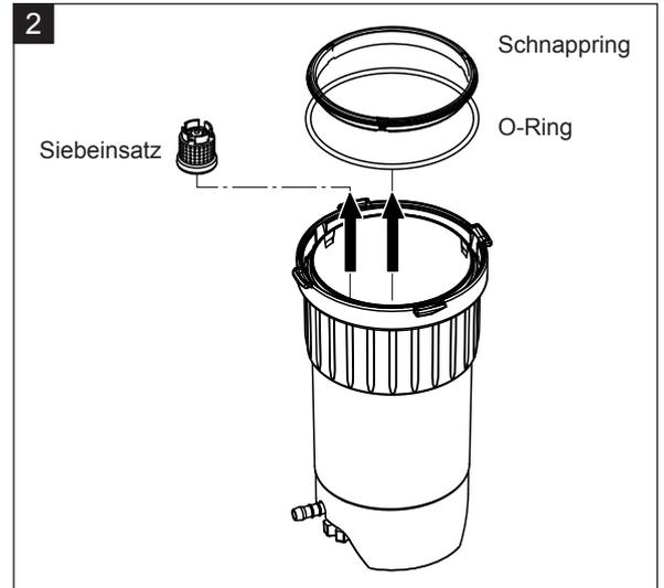
1. Lasche des Schnappverschlusses am Kalkauffangbehälter nach oben drücken und Verschlussring des Kalkauffangbehälter im Uhrzeigersinn drehen bis er ansteht (1.). Anschliessend Verschlussring bis zum Anschlag nach unten ziehen (2.) und dann im Gegenuhrzeigersinn drehen (3.) bis er ansteht. Kalkauffangbehälter nach unten ausbauen (4.)
