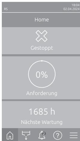
Betriebsstörungen, die einen Weiterbetrieb nicht zulassen oder zu Schäden an der Anlage führen können, werden mit einer Fehlermeldung signalisiert, zusätzlich leuchtet die Status-LED rot. Beim Auftreten einer solchen Störung ist der Betrieb des Condair RS nur noch beschränkt möglich oder der Condair RS **wird gestoppt**.
