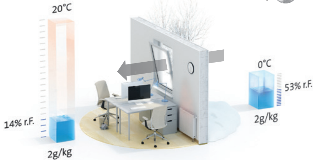
Situation der Raumluftfeuchte im Winter ohne aktive Luftbefeuchtung
