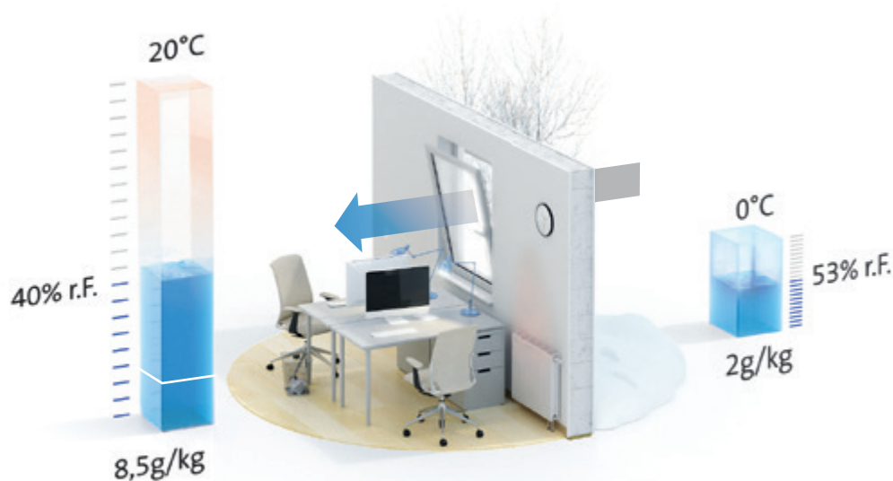
Situation der Raumluftfeuchte im Winter mit aktiver Luftbefeuchtung auf 8,5 g Wasser pro Kilogramm Luft
